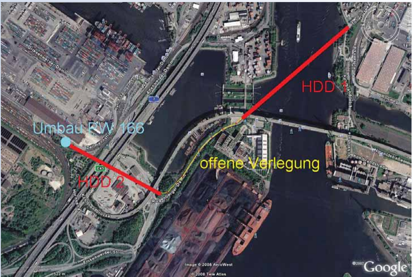
Übersicht über den geplanten Trassenverlauf
